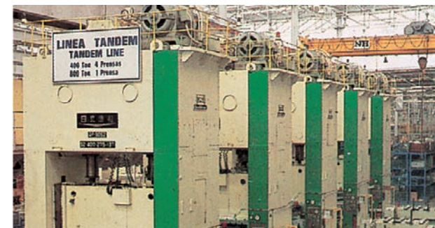
工場内部(400/800トン、タンデムライン)
