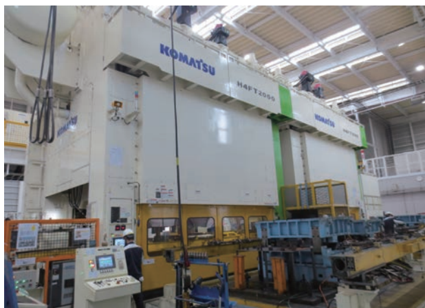
3,500トンサーボ・モジュール トランスファープレス機
