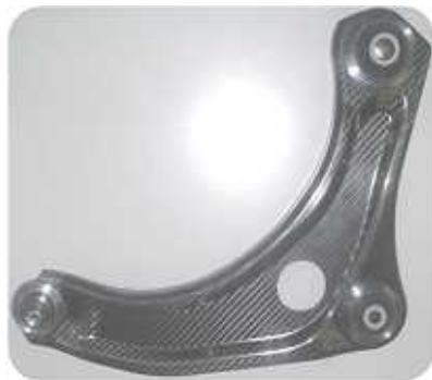
トランスバースリンク 試作品
