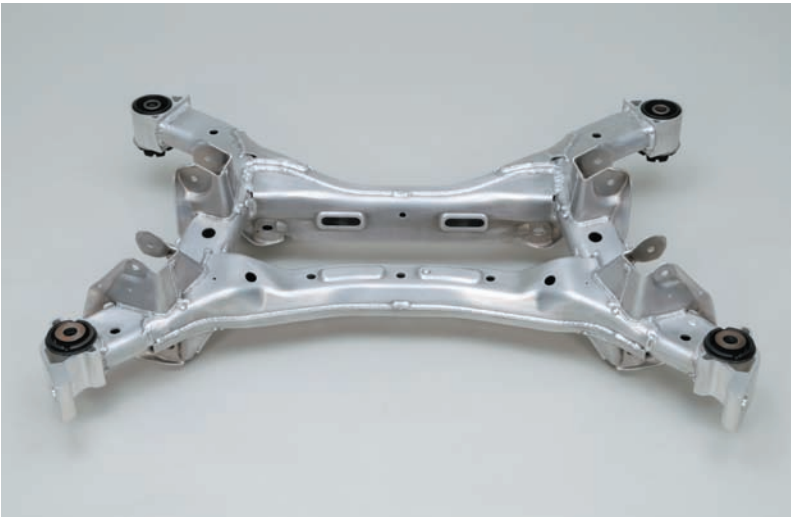
日産アルティマ用オールアルミの リアサスペンション All-aluminum rear suspension for the Nissan Altima
