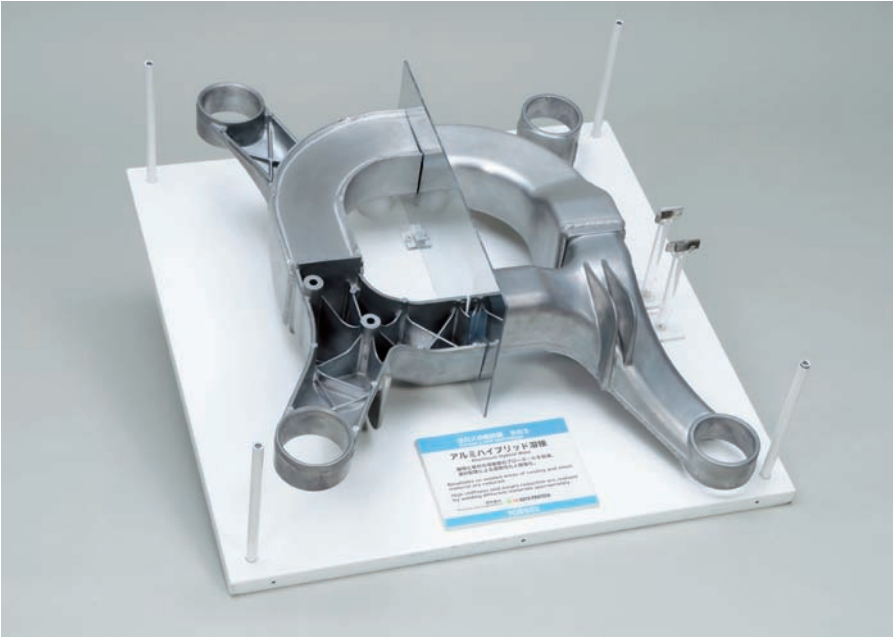
アルミ・ハイブリッド溶接（サンプル部品） Aluminum hybrid welding (sample product)
