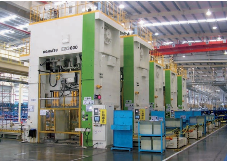
800・400トン大型タンデムプレスライン 800-ton and 400-ton tandem press lines
