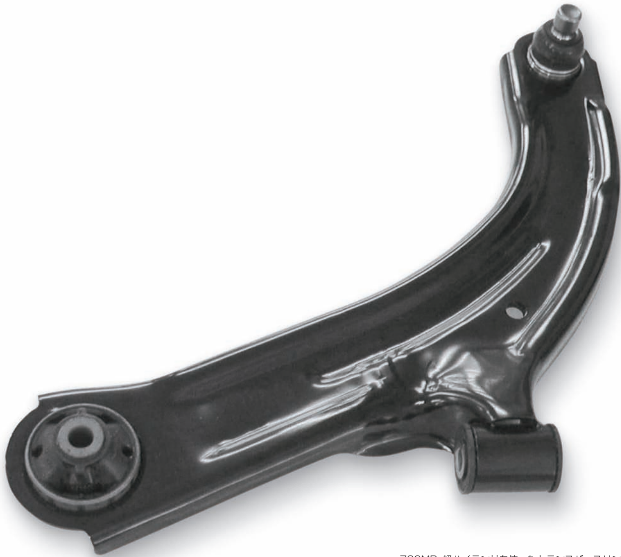
780MPa級ハイテン材を使ったトランスバースリンク試作品 Transverse link prototype using 780-MPa class high-tensile steel
