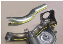
フルカール工法(鋼板のバイズ化)
