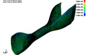
成型シミュレーションにより工程検討
